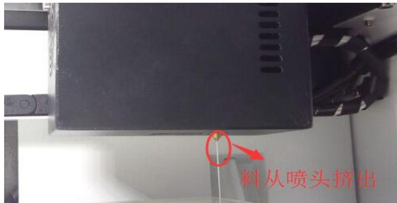
耗材快用完时，我们需要**暂停/停止**打印，然后按图中所示操作，机器会缓慢退料**约 30-45 秒**，之后电机开始快速退出耗材，直至完全退出。
